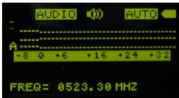
Дальность обнаружения зависит от мощности радиопередатчика закладного устройства и в среднем составляет от 0,5 до 3м.
