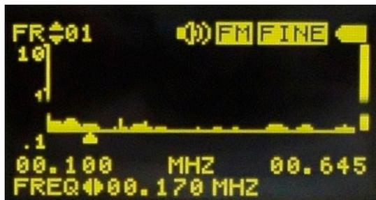
Для удобства работы и более детального анализа диапазон частот прибора поделен на части (frame) по 545 кГц.
